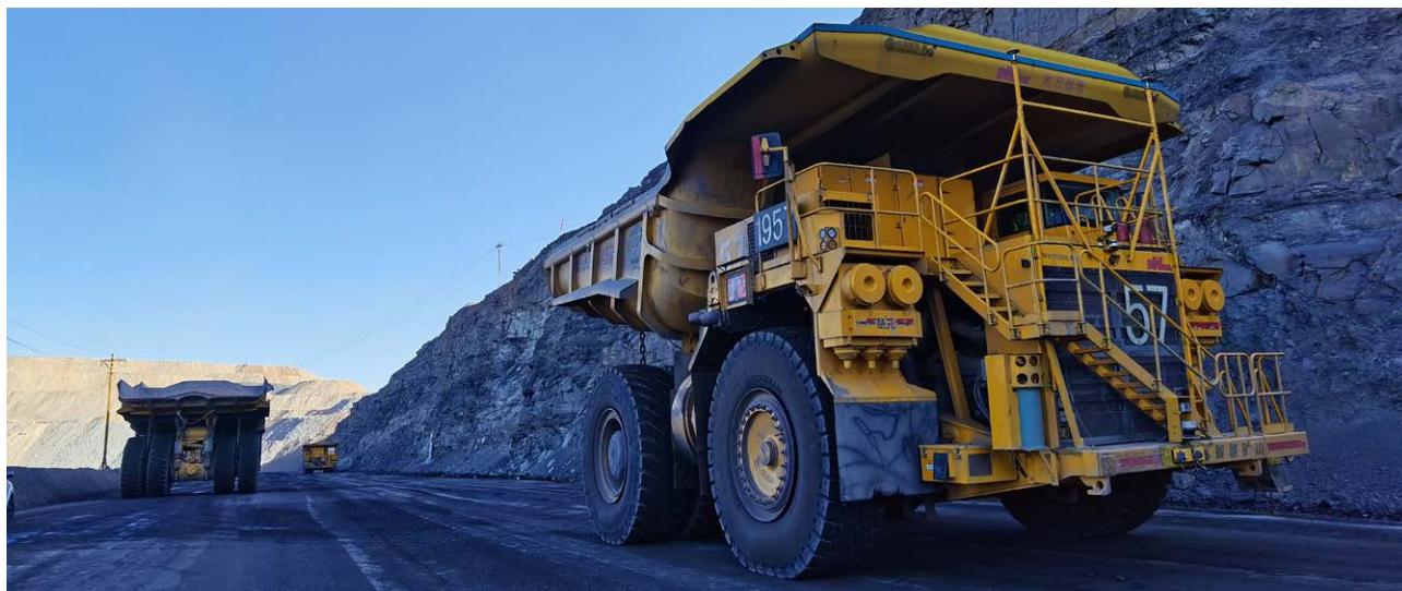
平朔集团东露天矿用卡车无人驾驶项目实现设备协同编组化运行
