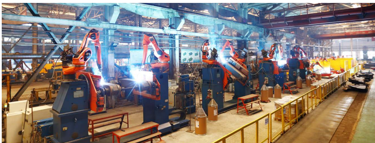
北煤机公司结构分厂连杆机器人生产线，广泛应用于各种液压支架连杆的焊接
