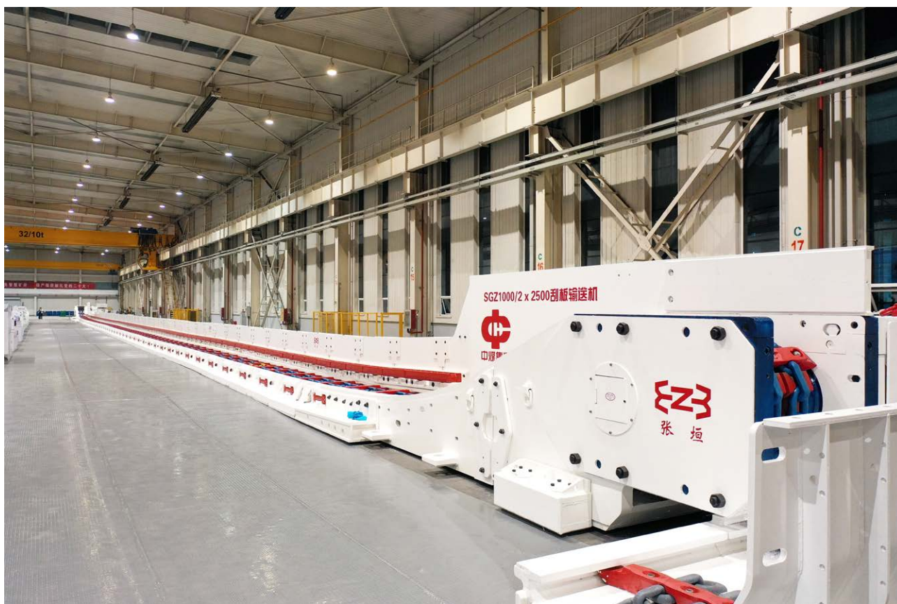
张煤机公司自主研发全国首台500米工作面智能刮板输送机
